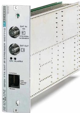
Le module SIG7710 est un encodeur qui fonctionne comme une passerelle de DVB-S (FTA) vers IP, le SIG7730 de DVB-T (FTA) vers IP. Les signaux satellite et numériques terrestres sont reçus en entrée sur le connecteur F, convertis en signaux selon la norme IP et transmis via le port de sortie RJ45 vers le réseau LAN.
