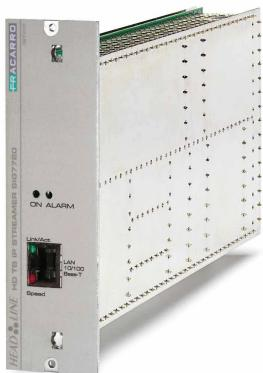
Le module SIG7720 est un encodeur fonctionnant comme passerelle de Transport Stream (TS) vers IP. Les signaux d'entrée peuvent être reçus d'un module SIG7100 (DVB-S2 à TS) ou d'un module SIG7540 (DVB-T), SIG7330 (DVB-S à TS), SIG7340 (DVB-S avec CI à TS).
