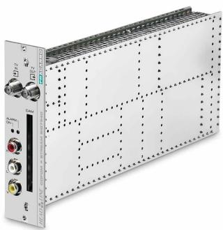
Récepteur numérique COFDM avec sorties A / V sur connecteurs RCA et TS sur le fond de panier pour la réception de programmes numériques terrestres en clair. Une entrée TV et une sortie en boucle pour brancher plusieurs récepteurs à la même antenne.
