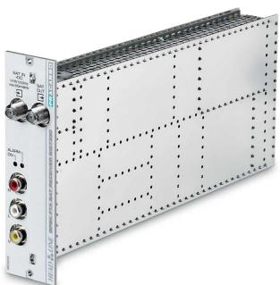
Récepteurs numériques QPSK avec sorties A / V sur connecteurs RCA pour la réception de programmes en clair transmis par satellite.
