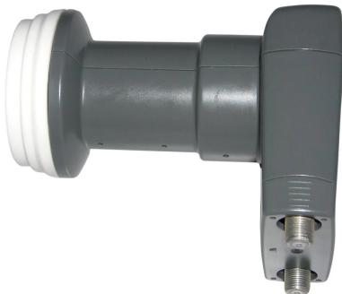
LNB avec une sortie SCD2 (dCSS) pour desservir jusqu'à 4 décodeurs SAT SCR et en même temps fournit les 12 fréquences nécessaires au décodeurs SCD2 (dCSS); ceci sur un seul câble coaxial et un simple répartiteur.
