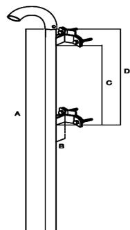
Postes curvos, fijaciones espaciadas 5 cm, accesorios de fijación de postes incluidos, curva desmontable de 180°, galvanizado en caliente
