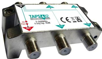
Derivador horizontal de 4 vías “top-down” con atenuación de 12dB y conector F en bandas de TV y Satélite (5-2400MHz).
