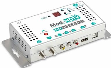
Modulatore digitale da interno di alta qualità DVB-T "Home" con ingresso RCA di backup; programmazione da tastiera con display o SW PC su porta USB.
