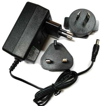
Alimentatore **12V 2A** su connettore Jack Maschio (2,5x5,5x12; interno positivo, esterno negativo) e adattatori per lo standard delle spine di diversi paesi.
