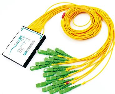
**Repartidor óptico de 16 vías** adecuado para la creación de ROE en edificios, con tecnología de guía de ondas planar que permite **pérdidas de inserción muy bajas**.
