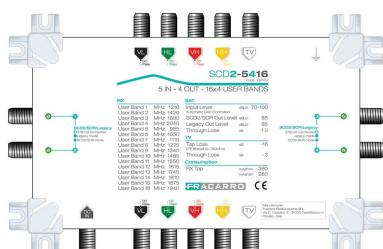
Multiswitch **SCD2 en cascade (dCSS)**, 5 entrées avec CAG et 4 sorties dérivées avec 16 fréquences chacune et **autodétection du mode de fonctionnement**, entièrement alimenté par le décodeur. Fréquences SKY Italia.
