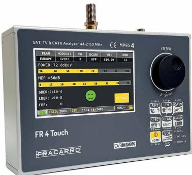
**Mesureurs de champ** Satellite DVB-S/S2,DVB-T/T2 et CATV DVB-C avec écran tactile 4".
