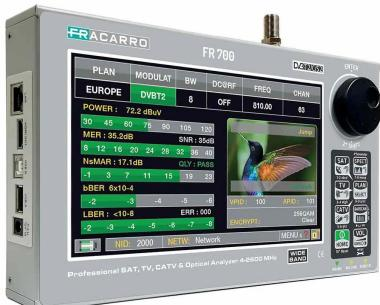
**Misuratori di Campo** combinati Satellite DVB-S/S2 TV DVB-T/T2 e CATV DVB-C con Touch Screen da 7". Completati di DiSEqC, con protocolli SCR e DCSS (SCD2) e wideband (opz). Compressione video MPEG 2 con qualità d'immagine Full HD o SD. FR700+ completo di misuratore ottico ed adattatori. Il corpo in metallo conferisce ai misuratori un robustezza adatta all'uso installativo.
