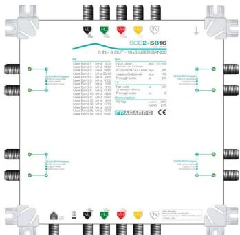
Multiswitch cascadable SCD2 (dCSS), 5 entrées avec CAG et 2, 4 ou 8 dérivés de 16 fréquences chacune, alimentés par décodeur.
