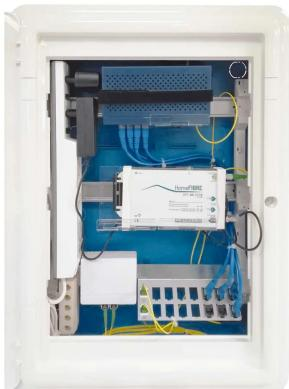
Caja de apartamento (54 módulos) para empotrar, completa con 2 barras DIN con ganchos para Router, dispositivos de conexión RJ45 activos para datos y latiguillos SC/APC para conexión al STOA (dimensiones 455x136x610mm incluido el marco, empotrada 592x427x100)
