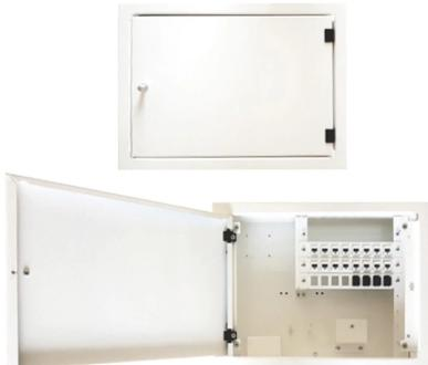
Boîtier plat métallique miniaturisé à montage mural pour le logement d'équipements actifs. Complet avec des panneaux pour les inserts KEYSTONE et des poches métalliques pour le logement de STOA (dimensions 390x305x110mm hors cadre)
