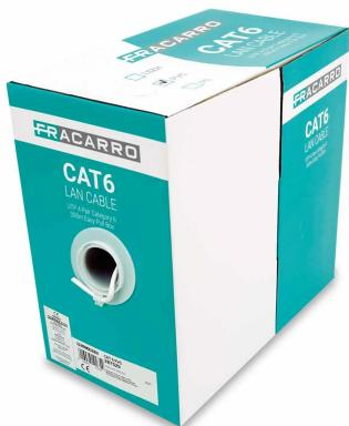
Cable de red interior CAT 6 con cubierta LSZH, bobina de 305 metros compuesta por 4 pares balanceados de 100 ohmios con conductores de cobre rojo flexibles AWG 24. Sus características cumplen con los requisitos de la Cat. 6 Clase E hasta 250 MHz, según las normas ANSI/TIA 568.2-D e ISO/IEC 11801. Apto para aplicaciones Gigabit Ethernet (IEEE 802.3ab).
