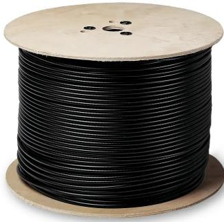
Câble réseau CAT 6 pour l'extérieur avec gaine PE noire, écheveau de 500 mètres comprenant 4 paires équilibrées de 100 Ohm avec des conducteurs flexibles en cuivre rouge AWG 24. Les caractéristiques répondent aux exigences de la **Cat. 6 Classe E** jusqu'à 250 Mhz selon ANSI/TIA 568.2-D et ISO/IEC 11801. Convient aux applications Gigabit Ethernet (IEEE 802.3ab).
