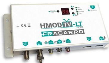
**Modulatore digitale** da interno di alta qualità DVB-T "Home" con **loopthrough** sulla porta di uscita HDMI; ingresso RCA di **backup** e programmazione da tastiera con display o SW PC su porta USB.
