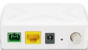
Terminal de red óptica (ONT) para recibir datos a través de fibra óptica.
