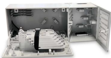
**Construcción de un Centro Óptico en Estrella** en material plástico (IP54) para sistemas multiservicio FTTH (CEI306-2), equipado con 48 espacios para alojar las tomas SC/APC. Recomendamos instalar un máximo de 8 STOA con empalme en caliente sobre pigtails o un máximo de 10 STOA con solución preconectorizada.
