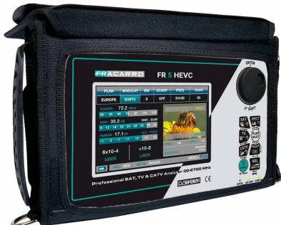
Mesureur de champ combiné Satellite DVB-S/S2 jusqu'à 2610MHz, TV DVB-T/T2 avec compression H265 HEVC Main 10 et CATV DVB-C écran tactile capacitif 5". Complet avec DiSEqC, avec protocoles SCR et DCSS (SCD2) et large bande. Compression vidéo MPEG 2 avec qualité d'image Full HD ou SD. Le corps métallique confère au compteur une robustesse adaptée à une utilisation en installation.
