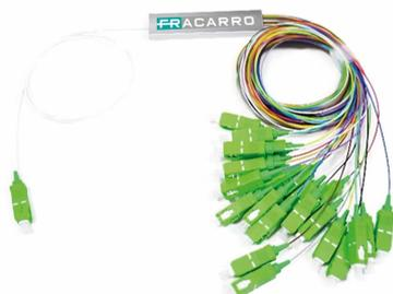
**Partitore ottico PLC miniaturizzato a 24 vie** adatto alla realizzazione dei ROE di edificio, con tecnologia planar waveguide che consente **bassissime perdite d'inserzione**. Adatto per una distribuzione ottica a basso costo ed a alte prestazioni, si presta all'utilizzo in innumerevoli tipologie installative.
