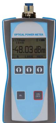
El medidor de potencia certificado **CERT-OPT-METER** es adecuado para verificar y certificar sistemas FTTH multiservicio y diversas distribuciones de fibra óptica. Medición de potencia óptica absoluta o relativa. Longitud de onda seleccionable (850-1300-1310-1490-1550-1625 nm). Funcionalidad AWD (reconocimiento automático de la longitud de onda entre la fuente óptica y el medidor de potencia). Incluye fuente de alimentación de pared con salida USB.
