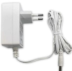
Fuente de alimentación de 12 V y 1,5 A con conector Jack macho (2,1 x 5,5 x 12; positivo interno, negativo externo) y enchufe europeo.
