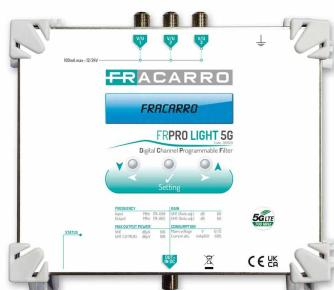
**Central programmable para filtrado altamente selectivo de canales de TV con 3 entradas VHF+DAB / UHF flexibles y un nivel de salida de 108dB $\mu$ V para cada filtro. 32 filtros de 1 a 6 canales, cada uno con 9 niveles de selectividad.**
