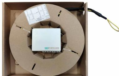
**Boîte de terminaison optique plate en plastique**, pré-connectée des **deux côtés**, avec 4 prises SC/APC et tireur ; disponible avec **60m** de câble à 4 fibres pour les installations **FTTH** multi-services ; solution très utile pour amener tous les services centralisés dans le CSOE des installations FTTH à l'intérieur de chaque unité d'habitation individuelle.
