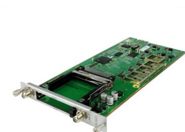
El módulo GX-4S2CI-BP-01 está equipado con dos entradas coaxiales de RF para satélite y dos ranuras de interfaz común PCMCIA. Puede sintonizar hasta cuatro transpondedores de satélite DVB-S/S2/S2X (dos por cada entrada coaxial de RF), decodificar programas cifrados mediante las tarjetas CAM y las tarjetas inteligentes correspondientes insertadas en las ranuras CI correspondientes y compartir contenido a través del panel trasero del chasis GALAXIA.
