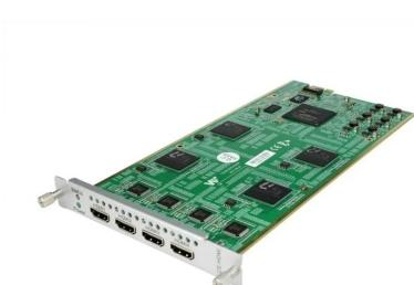
El codificador HDMI multientrada **GX-4HDMI-BP-R01** cuenta con cuatro conectores HDMI hembra. El módulo permite codificar hasta cuatro fuentes HDMI externas en modo H.264 HD/SD o MPEG-2 SD y compartir el contenido a través del panel trasero del chasis GALAXIA.
