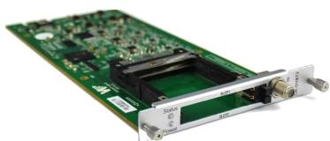
El **GX-4T2CI-BP-00** es un receptor digital terrestre equipado con un conector de entrada coaxial RF (F hembra) y dos ranuras PCMCIA de interfaz común. El módulo puede sintonizar hasta cuatro múltiplex digitales terrestres DVB-T/T2, descifrar programas codificados mediante CAM y tarjetas inteligentes insertadas en las respectivas ranuras CI, y compartir contenido a través del panel trasero del chasis GALAXIA.
