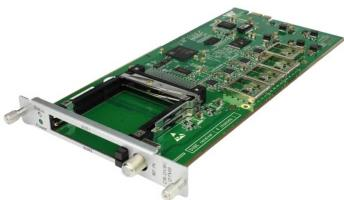
El **GX-4C2CI-BP-00** está equipado con un conector de entrada coaxial RF (F hembra) y dos ranuras PCMCIA de interfaz común. El módulo puede sintonizar hasta cuatro multiplexores QAM digitales DVB-C, decodificar programas encriptados mediante las CAM y tarjetas inteligentes correspondientes que se pueden insertar en las ranuras CI y compartir contenido a través del panel posterior del chasis GALAXIA.
