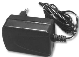
**Fuente de alimentación 12V y 2A con conector Jack macho (2,1x5,5x12; positivo interno, negativo externo) y enchufe europeo.**
