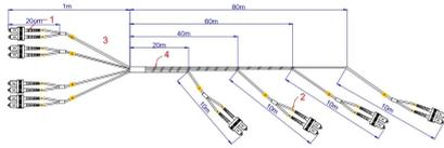
**Câble fibre optique** monomode G652D pour intérieur avec **8 fibres** et longueur de **90m**, étagée **tous les 20m** avec **10m de fibre préconnectorisée** avec **SC/APC Duplex** et système de traction **PULL**.
