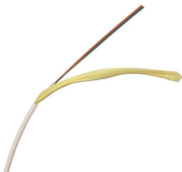
Câble intérieur en fibre optique gainé LSZH avec 8 fibres monomodes 9/125 Classification CPR Cca, s1a, d0, a1.
