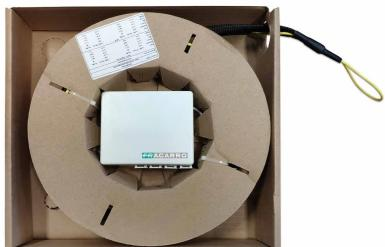
**Caja de Terminación Óptica de Plástico para Apartamentos**, preconectorizada por ambos lados, con 4 conectores SC/APC y disparador; disponible con 30 m de cable de 4 fibras para sistemas FTTH multiservicio; una solución muy útil para integrar todos los servicios centralizados en la CSOE de los sistemas FTTH en cada vivienda individual.
