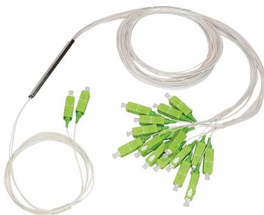
Diviseur optique PLC miniaturisé avec 2 entrées et 16 sorties adapté à la réalisation de la redondance dans les systèmes GPON; équipé de la technologie planar waveguide qui permet de très faibles pertes d'insertion.
