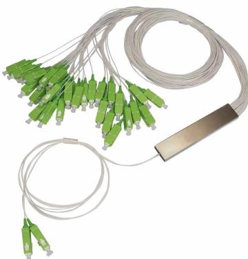
Diviseur optique PLC miniaturisé avec 2 entrées et 32 sorties adapté à la réalisation de la redondance dans les systèmes GPON; équipé de la technologie planar waveguide qui permet de très faibles pertes d'insertion.
