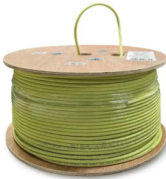
Cable de red CAT 6 U/UTP Cca para interior con cubierta LSZH, bobina de 305 metros compuesta por 4 pares balanceados con conductores de cobre rojo flexible AWG 23. Sus características cumplen con los requisitos de CAT 6 hasta 250 MHz según las normas ANSI/TIA 568-C.2 e ISO/IEC 11801. Apto para aplicaciones Gigabit Ethernet (IEEE 802.3ab).
