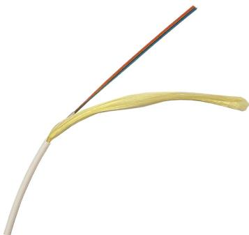
Cable de fibra óptica monomodo de interior con ocho fibras 9/125 (categoría A G.657). Clasificación CPR: Cca, s1a, d0, a1.
