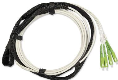
Cable de fibra óptica monomodo 9/125 precableado para uso interior, insensible a la curvatura, con 4 fibras conectorizadas SC/APC y sistema de tracción PULL, de 40 m de longitud.
