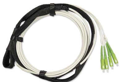
Cable de fibra óptica monomodo 9/125 precableado para uso interior, insensible a la curvatura, con 4 fibras conectorizadas SC/APC y sistema de tracción PULL, de 100 m de longitud.
