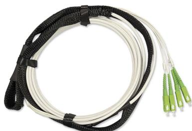
Cavo ottico precablato in fibra monomodale 9/125 per uso interno, bend insensitive, con **4 fibre connettorizzate SC/APC** e sistema di trazione **PULL**, lungo 100 m.
