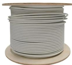
Cable de red CAT 6 F/UTP para interiores con revestimiento LSZH y blindaje de aluminio, rollo de 305 metros, compuesto por 4 pares balanceados de 100 ohmios con conductores flexibles de cobre desnudo AWG 23. Sus características cumplen con los requisitos de la categoría 6 Clase E hasta 250 MHz, según las normas ANSI/TIA 568.2-D e ISO/IEC 11801. Apto para aplicaciones Gigabit Ethernet (IEEE 802.3ab).
