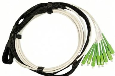
Cavo ottico precablato in fibra monomodale 9/125 per uso interno, bend insensitive, con **8 fibre connettorizzate SC/APC** e sistema di trazione **PULL**, lungo 30 m.
