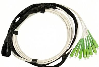
Cable de fibra óptica monomodo 9/125 precableado para uso interior, insensible a la curvatura, con 8 fibras conectorizadas SC/APC y sistema de tracción PULL, de 80 m de longitud.
