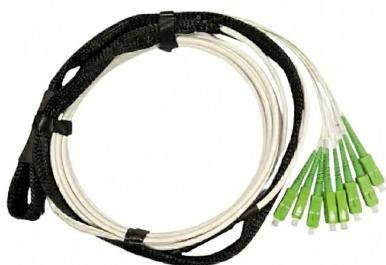
Câble optique pré-câblé en fibre monomode 9/125 pour usage intérieur, insensible aux courbures, avec **8 fibres connectées** SC/APC et un système de traction **PULL**, d'une longueur de 90 m.
