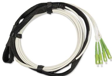
Câble optique pré-câblé en fibre monomode 9/125 pour usage intérieur, insensible aux courbures, avec **4 fibres connectées SC/APC** et un système de traction **PULL**, d'une longueur de 100 m.
