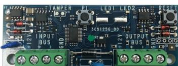
Le MOD-ISOBUS est un dispositif qui permet de régénérer le BUS RS485, au cas où il serait nécessaire de parcourir des distances supérieures à celles autorisées par les panneaux de contrôle Defender, tout en isolant et en protégeant le BUS RS485 et tous les dispositifs connectés en amont du module, ce qui permet au système de fonctionner correctement même en cas de manipulations, de courts-circuits et de surtensions, tant de l'alimentation que du BUS lui-même, en aval du module.
