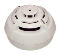
Rivelatore di temperatura in grado di rivelare un incremento di temperatura oltre una soglia impostata, o un incremento repentino di temperatura in un arco di tempo ristretto (anche senza superare la soglia limite). Dotato di relè per interfacciamento con sistemi antintrusione.
