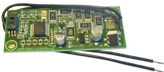
Kit de chauffage pour les détecteurs filaires et sans fil de la série SHIELD. En cas de connexion avec des détecteurs SHIELD sans fil (SHIELD C/WL 910380 et SHIELD V/WL 910381), une source d'alimentation externe de 12 Vcc doit être connectée.
